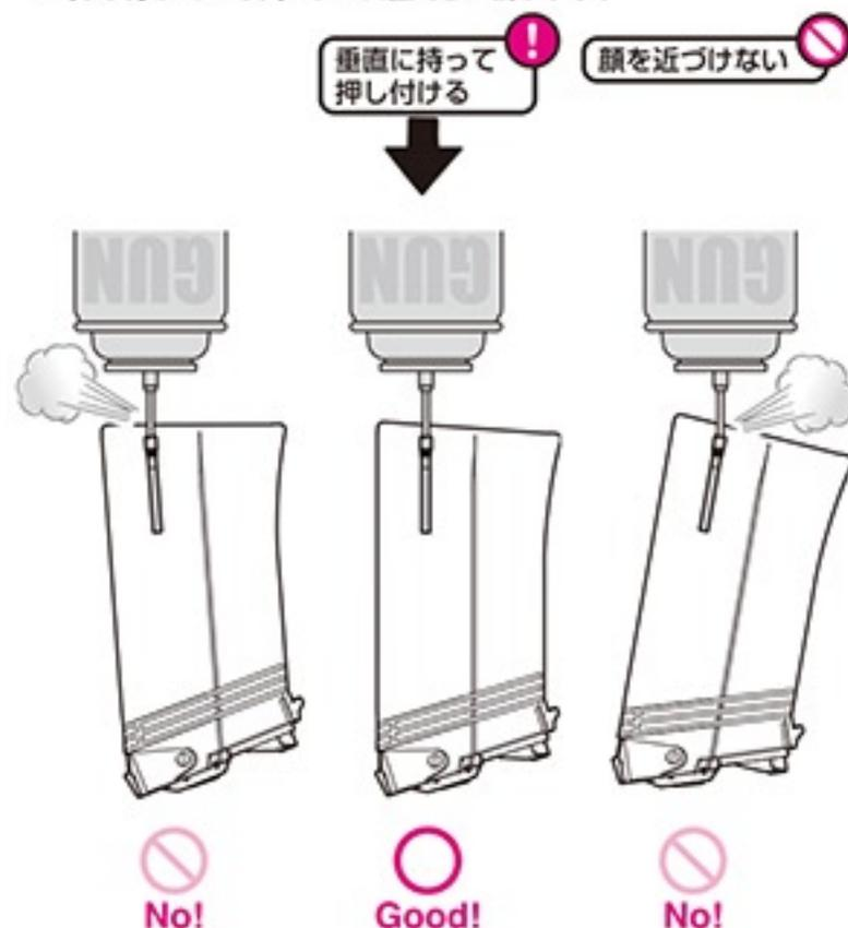
\*注入を始めた途端にバルブからガスが噴き出す場合は、バルブとノズルがズれていたり、マガジンとガスポンベが一直線になっていません。
