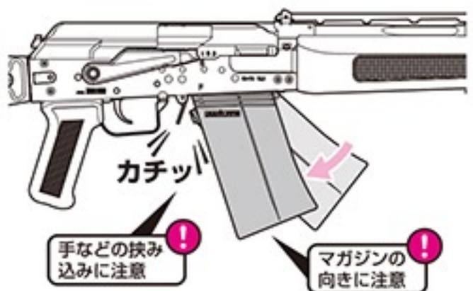
**注意!** 正しくセットされていないとマガジンが落下する危険性がありますので、下に引っ張って正しくセットされているか確認してください。
