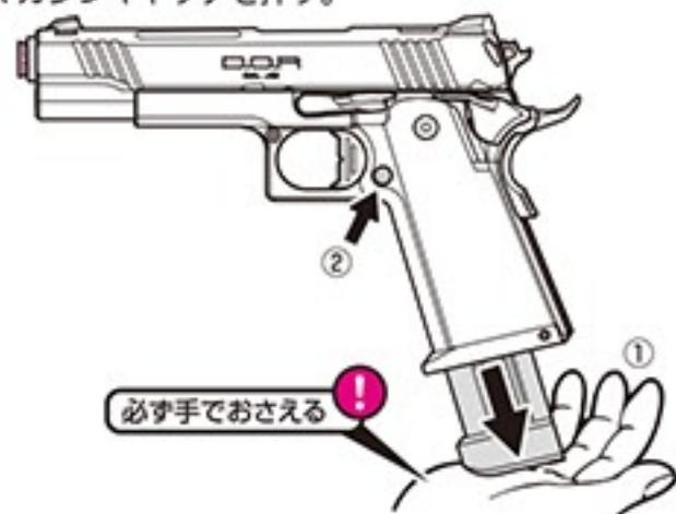
※マガジンキャッチを押すと、マガジンが抜け落ちてきます。
