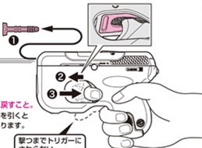
※発射後、トリガーはしっかり戻すこと。十分に戻さずに再度トリガーを引くと重複して給弾される場合があります。
