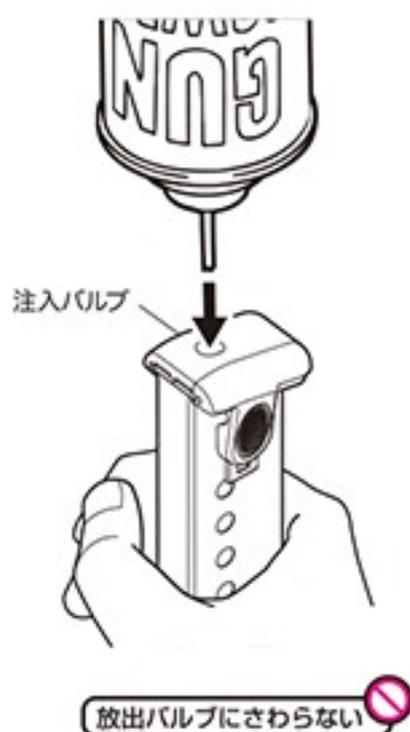
② マガジンとガスポンベを一直線にして垂直に持ち、ガスポンベをマガジンに押し付ける。
