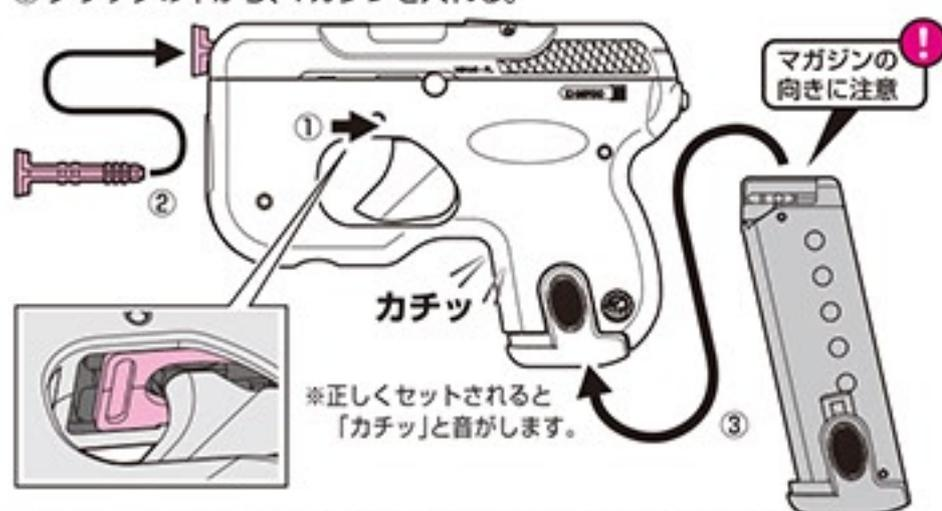
**!** **警告** マガジンを叩き込むような勢いで本体にセットしないでください。本体が破損したり誤作動を起こす原因になります。
