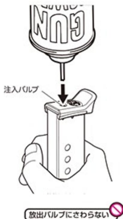
**②** マガジンとガスポンベを一直線にして垂直に持ち、ガスポンベをマガジンに押し付けます。
