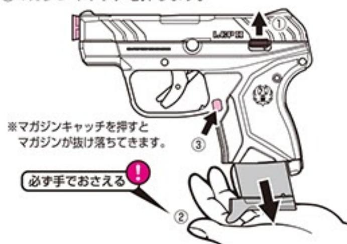
**⚠ 警告** マガジンを叩き込むような勢いで本体にセットしないでください。本体が破損したり誤作動を起こす原因になります。
