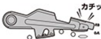
安全装置は解除状態 セクターレバー位置 <AB>
