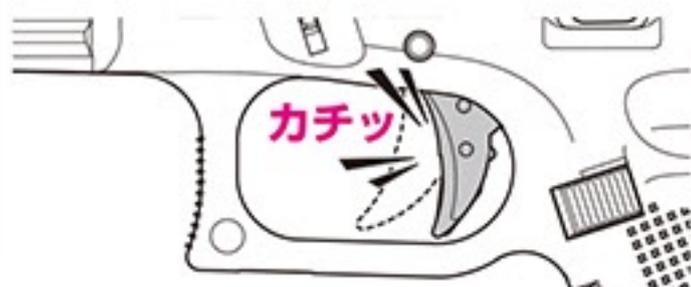
図のようにトリガーが後退したままロックされた場合、内蔵式ローラーハンマーはハンマーダウンの状態になっています。マガジンのセット(P8 4-1)を行い、初弾を送弾する事で、フルコックになると同時にトリガー位置が通常の位置に戻り、BB弾の発射が可能になります。
