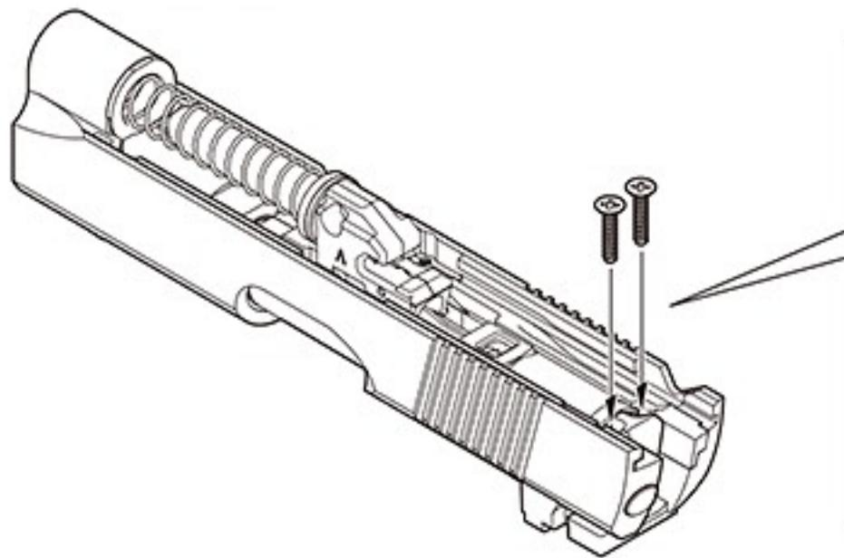
ネジを使用する前にマイクロプロサイト用ベースが正しい位置にある事を確認してください。
