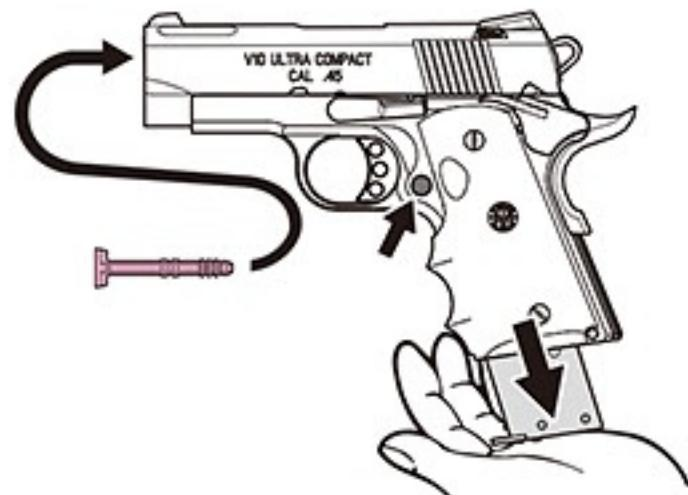
③ スライドアッセンブルを20mm程度後退させて、スライドストップのツメ部分とスライドの切り欠き部分を合わせ、スライドストップを抜き取る。
