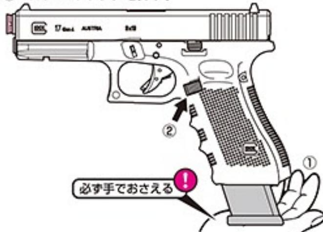
\*マガジンキャッチを押すと、マガジンが抜け落ちてきます。
