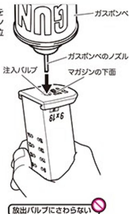
② ガスポンベのノズルを注入バルブに 6~7mm 程度差し込み、ガスポンベをマガジンに押し付ける。
