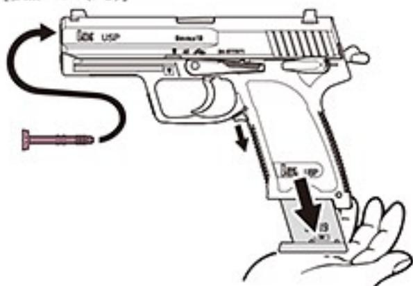
❷ スライドアッセンブルを後退させて切り欠きを合わせ、スライドストップを銃の裏側から押して抜き取ります。
