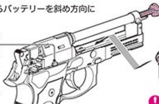
スライドが外れていると、セカンドセフティが上に上がり、トリガーをロックします。（無理やりトリガーを引くと破損します。）
