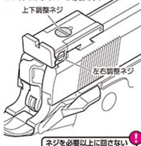
※ネジをしめすぎるとパーツが破損するおそれがあります。また、ゆるめすぎると調整ネジが外れてしまいます。
