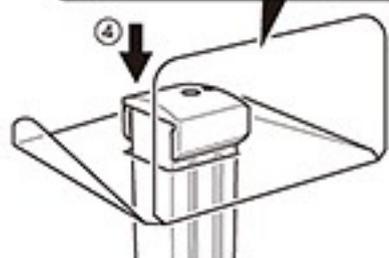
※注入カバーの穴に、マガジンを上から通します。「A」の文字がある方に、マガジンのフォロアーが向くようにしてください。
