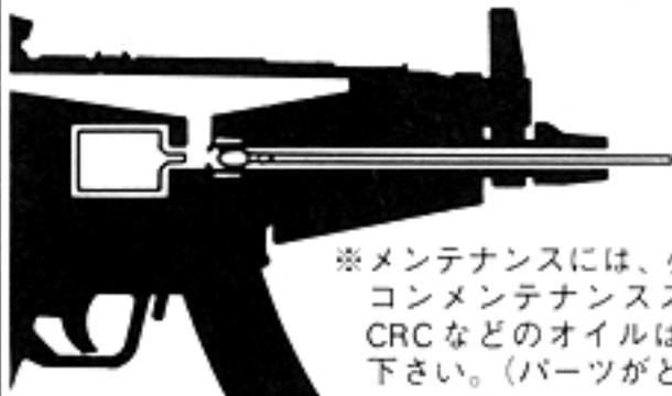
全長160mm位の細いプラスチックの棒を用意し、脱脂綿を棒にしっかり固定し、シリコンオイルをしみ込ませてバレルの中をクリーニングします。
