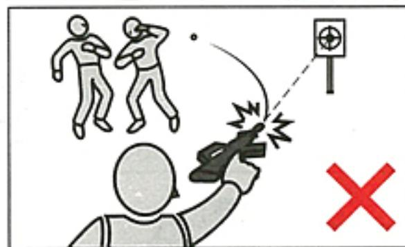
ホップアップシステムは、タマが回転しながら飛びますので、ガンをたおして発射するとタマが左右に大きく曲がって飛び、キケンです。ガンは必ずふつうに立てて発射してください。
