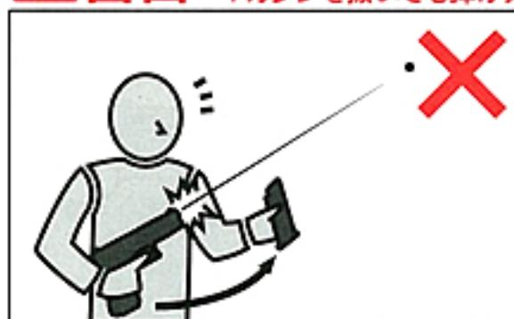
マガジンを抜いてもガン内部に弾が残っている場合があり、不用意に引き金を引くと発射され、危険です。マガジンを抜いた後、銃口を安全な方向に向けて撃ち、弾が残っていない事を確認してから、銃口に保護キャップをして保管して下さい。
