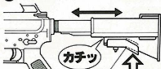
●レバーを押すとロックがはずれ、ストックを引き出せます。戻すときも、レバーを押してストックを押し込んで下さい。
