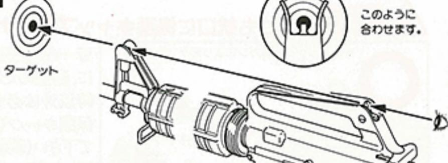
●弾が一定方向にそれる場合は、サイト調整治具を使い下の方法で調整して下さい。
