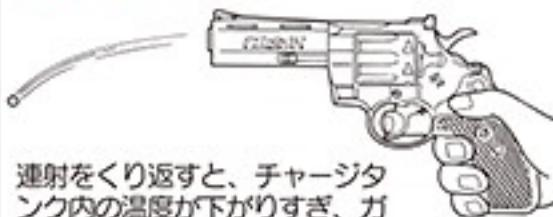
連射をくり返すと、チャージタンク内の温度が下がりすぎ、ガス圧が低下するため、弾の飛びが悪くなりますか故障ではありません。時間を置いてチャージタンクの温度が20°Cくらいまで回復すれば正常に作動するようになります。
