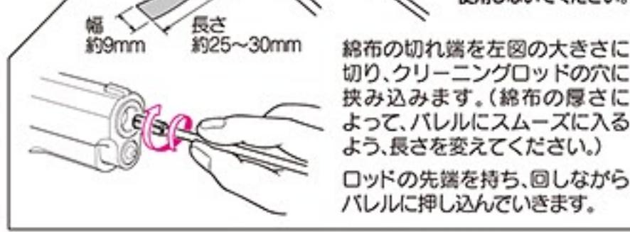
綿布の切れ端を左図の大きさに切り、クリーニングロッドの穴に挟み込みます。(綿布の厚さによって、バレルにスムーズに入るよう、長さを変えてください。)
