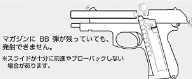
マガジンを外してガスを注入し、残弾を全て発射する。
