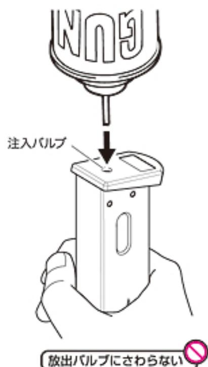
② マガジンとガスポンペを一直線にして垂直に持ち、ガスポンペをマガジンに押し付ける。
