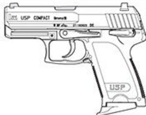
この製品は、ガスの圧力を利用して“BB弾の発射”と“スライドの後退および次弾の装填”を行う、セミオートマチックタイプの「ガスブローバック」モデルです。製品の性能や特徴をよく理解し、正しい操作方法を身につけ、ルールやマナーを守ったスポーツシューティングをお楽しみください。
