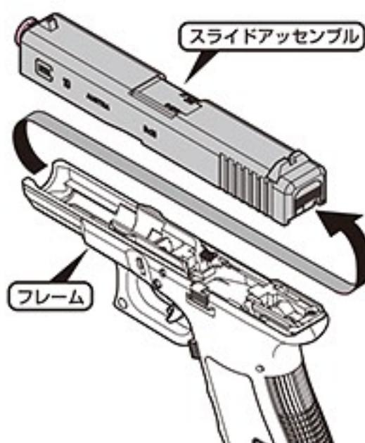
④ リコイルスプリングアッセンブルを前方に押し、リコイルスプリングを圧縮したまま、アッセンブルを引き抜く。
