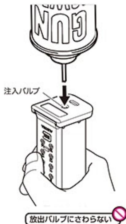
② マガジンとガスポンペを一直線にして垂直に持ち、ガスポンペをマガジンに押し付ける。
