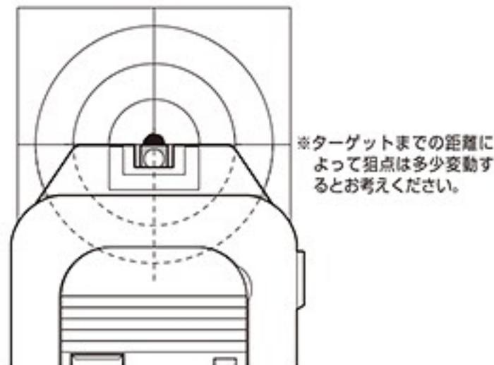
※ターゲットまでの距離が近いと、下図の通りにサイティングしても狙いより下に着弾します。この製品の特性上、フロント/リアサイトに着弾点の調節機能はありませんので、着弾点が下がっている場合はターゲットの上を狙うようにしてください。
