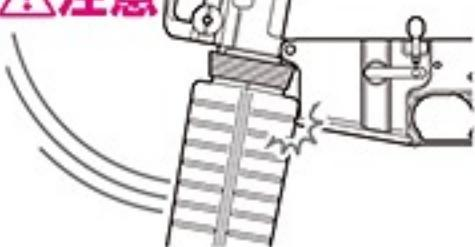
フレーム上を勢い良く持ち上げたり、フレーム上下いずれかから手をはなすと自重で回転し、ロアフレーム先端とハンドガードが衝突し、キズがつきります。また、手を挟むとケガをする恐れがあります。
