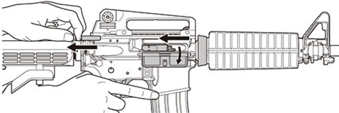
\*チャージングハンドルを引くと運動してboltが後退し、又、それにより内部のハンマーもフルコック状態に回転させられます。
