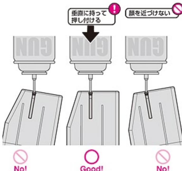
※注入を始めた途端にバルブからガスが噴き出したら、バルブとノズルがズレていたり、ガスタンクとガスピボンベが一直線になってしまっています。
