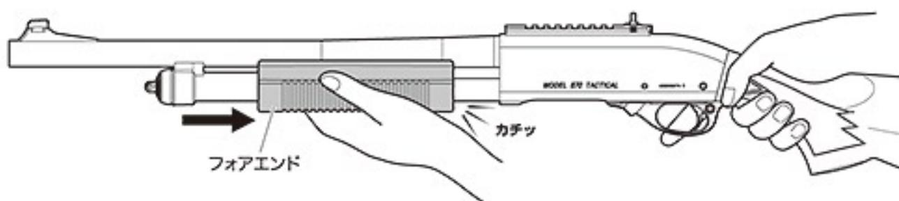
※本体を片手のみで操作したり、フォアエンドを速く引き過ぎると破損や給弾不良の原因になります。
