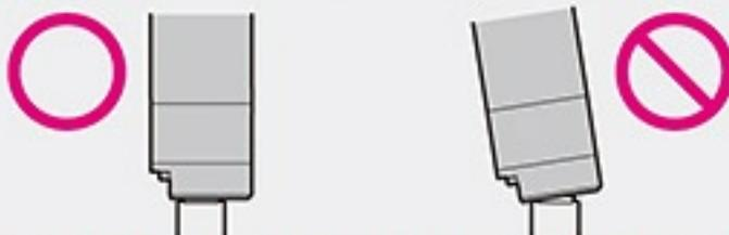
⚠ 逆ネジ部の形状から、取り付けの際に曲がってネジ込みやすいので注意してください。
