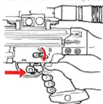
③ コッキングレバーを一番後ろまで引き、初弾を送弾します。(この操作を行わないと、一発目はカラ撃ちとなります。) コッキングレバーは、そのまま元の位置に戻します。Pull the cocking lever all the way to feed the first bullet. (A blank firing occurs to the first bullet unless this operation is done.) Return the cocking lever to the original position.
