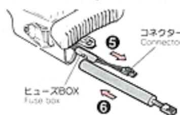
**7** 下図のようにストック内のリブをさけて、ななめにバッテリーを入れ、コネクターをつなぎます。コードとコネクターは下図のように収めます。
