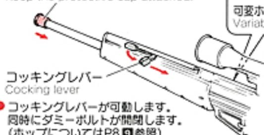
● コッキングレバーが可動します。同時にダミーボルトが開閉します。(ホップについてはP8参照)
