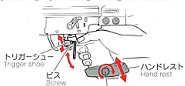
● ハンドレストが上下可動します。調整用ネジを緩め、上・下に位置をずらし、手の下が少し当たる位に調整するとよいでしょう。調整後、調整用ネジを締めます。
