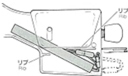
**8** コードをはさまないようにストッパーを矢印の方向に押しながらフタを閉めます。②→①の手順でバットプレートを戻します。
