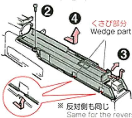
④ コッキングレバー・バッテリー収納部品を後ろへ下げながら取り外します。かみ合わせがくさび形になっていますので交換後の組立には注意して下さい。
