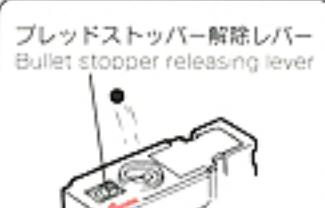
矢印の方向にレバーをスライドさせると、撃ち残ったBB弾を取り出せます。(飛び出すので注意してください。)
