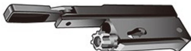
●本体からボルトアッセンブリーを取外したところ
