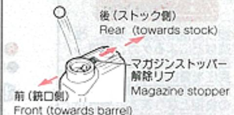
**注意** ストッパーを解除すると残ったBB弾が勢いよく飛び出しますので、十分に注意してください。
