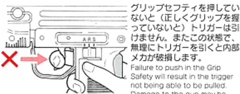
グリップセフティを押していない (正しくグリップを握っていない) とトリガーは引けません。またこの状態で、無理にトリガーを引くと内部メカが破損します。
