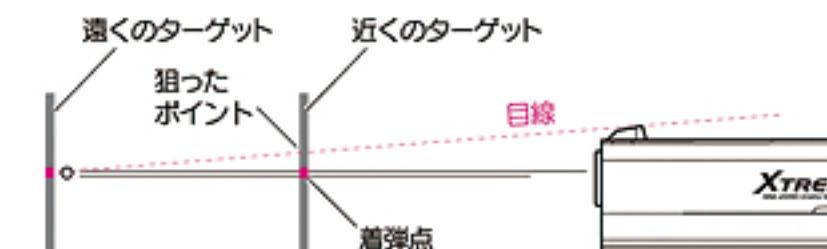
※ターゲットまでの距離が近いと、左図の通りにサイティングしても狙いより下に着弾します。この製品の特性上、フロント/リアサイトに着弾点の調節機能はありませんので、着弾点が下がっている場合はターゲットの上を狙うようにしてください。
