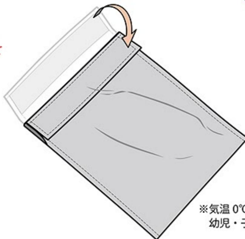
保管時・移動時は、万が一発火した場合に備えて、必ずバッテリーをセーフティバッグに入れてください。
