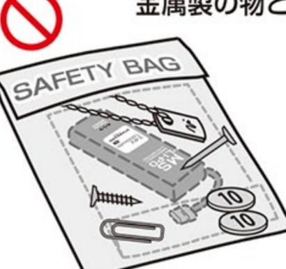
バッテリーと金属製の物(針金・釘・ネジ類・クリップ・ヘアピン・金属製ネックレス等)と一緒にして持ち運びや保管した場合、ショートして発熱・発煙・発火等の恐れがあります。
