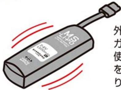
外装が膨らんだバッテリーは可燃性のガスが発生している危険性があるため、使用や充電、ストレージモード等の作業をしないこと。破裂・発火等の恐れがあります。
