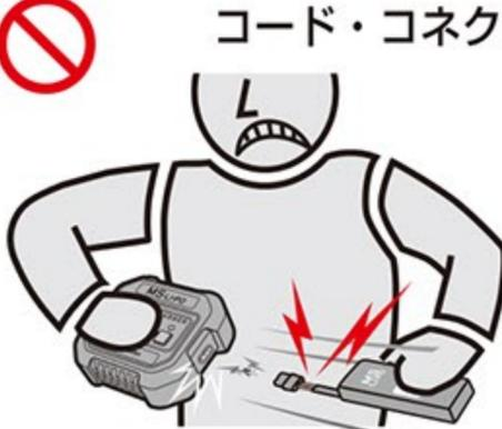
コネクタを抜く際、ケーブルをムリに引っ張って外すとコードの芯線がむき出しになったり断線する恐れがあり、ショート・発熱・発煙・発火等の恐れがあります。必ずコネクタ部分を正しく持って抜き差ししてください。
