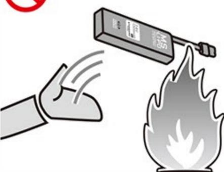
MS・Li-Poバッテリーを火の中に投げ込まないこと。電子レンジ等での加熱もしないこと。発熱・破裂・発火等の恐れがあり非常に危険です。
