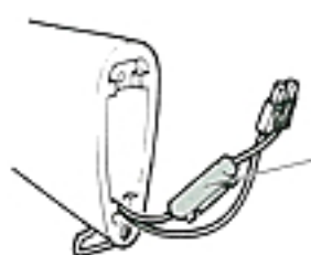
ヒューズBOX (交換し終わったら奥に押し込んでおきます。) Fuse box (When fuse is replaced, push into the stock all the way.)
