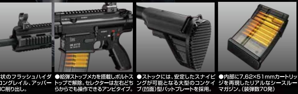
2007年、アメリカのSHOT SHOWで公開された<HK417 Weapon System>は、先行開発されていた<HK416>の口径拡大バージョンである(7.62×51mm弾使用)。開発に際して、現場の意見を取り入れるべく、HK社は各国の特殊作戦部隊の担当者と直接作業を実行。<民間メーカー主導型>の開発が行なわれた結果、より実戦的で質の高いウェポンに仕上がった。バレル長は12、16、20インチ(305、406、508mm)のバリエーションが存在。交換が容易なので、ハーフライフルからスナイパーライフルまで各射程距離をカバーすることができる。内部機構にはショートガスブースト方式を採用。内部メカの熱問題や発射ガスによる汚れを軽減することで10,000~15,000発までバーツの摩耗や精度劣化を防いでいる。初期段階モデル(通称:アーリーバリアント)は各種の形状や組合せ、マーキングが存在し(D刻印有り無し)各国独自の仕様に合わせた<HK417>が多く配備されている。
